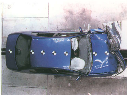
Energię zderzenia pochłonęła część przednia a przestrzeń przeżycia pozostała wystarczająca.
