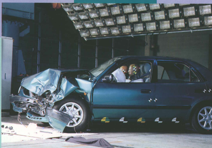
ZDERZENIE CZOŁOWE. NIENARUSZONA KABINA KIEROWCY
